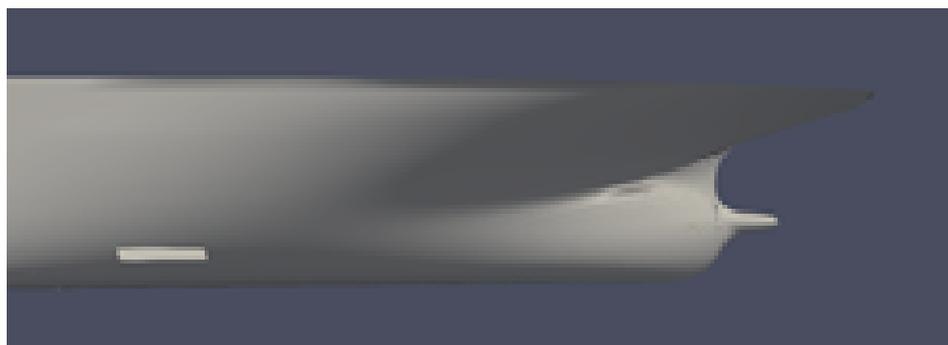
Fig. 4.5-4 船体 FIN の設置位置 (at SS2、基線の 20% d 上方) 石川 [69]
