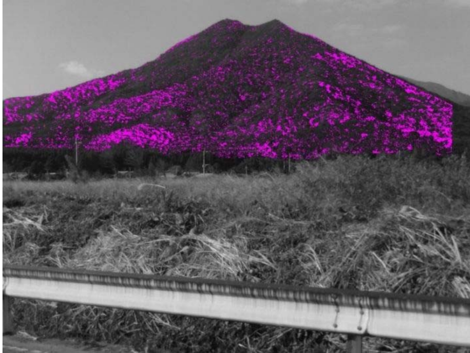
図 6-25 分解画像による土壌水分の少ない箇所の強調画像 (対象地：鹿屋市)
