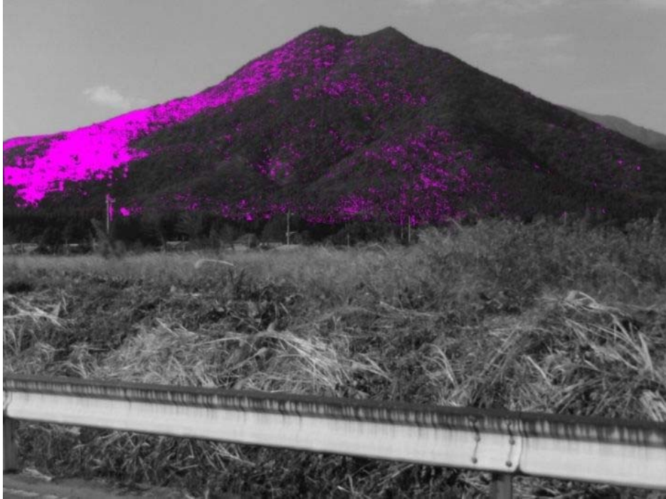
図 6-24 分光画像による土壌水分の少ない箇所の強調画像 (対象地：鹿屋市)
