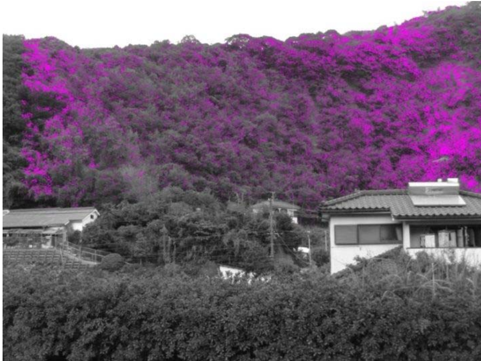
図 6-22 分光画像による土壌水分の少ない箇所の強調画像 (対象地：鹿児島市)
