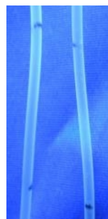
図 4-5-2-13 ラクテック 4 回目 3 時間後の輸液ライン 左：球状浮力体あり 右：球状浮力体なし
