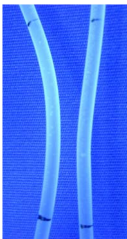
図 4-5-2-37 アミノトリパ 3 回目 図 4-5-2-38 アミノトリパ 3 回目 図 4-5-2-39 アミノトリパ 3 回目 90 分後の輸液ライン 120 分後の輸液ライン 150 分後の輸液ライン 左：球状浮力体あり 左：球状浮力体あり 左：球状浮力体あり 右：球状浮力体なし 右：球状浮力体なし 右：球状浮力体なし
