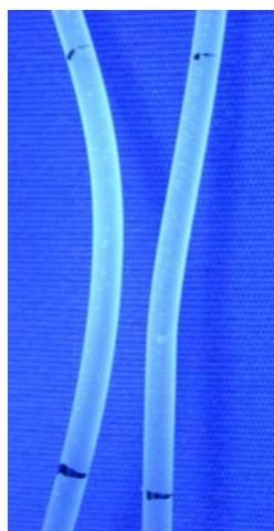
図 4-5-2-37 アミノトリパ 3 回目 図 4-5-2-38 アミノトリパ 3 回目 図 4-5-2-39 アミノトリパ 3 回目 90 分後の輸液ライン 120 分後の輸液ライン 150 分後の輸液ライン 左：球状浮力体あり 左：球状浮力体あり 左：球状浮力体あり 右：球状浮力体なし 右：球状浮力体なし 右：球状浮力体なし
