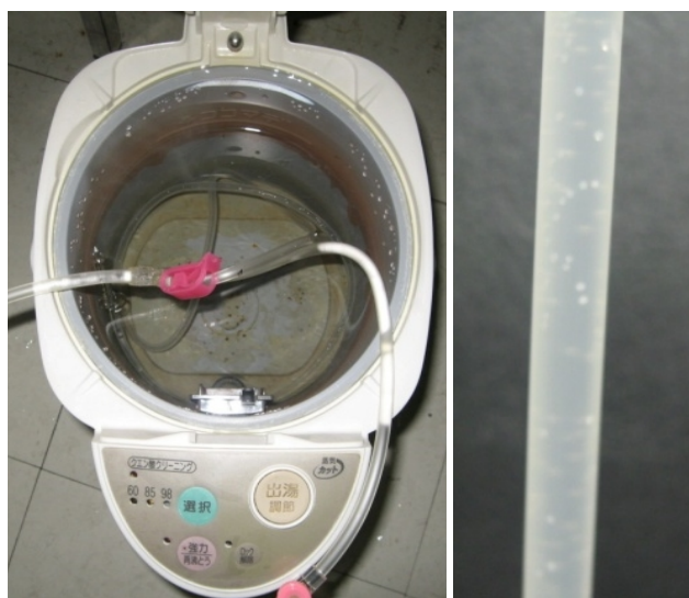
図 5-1-1-1 水の加温による気泡の発生
