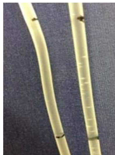
図 4-5-2-2 ラクテック 1回目 1 時間後の輸液ライン 左：球状浮力体あり 右：球状浮力体なし
