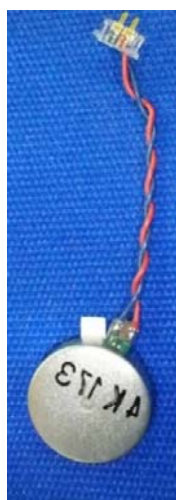
図 5-1-2-1 振動モータ（扁平モータ）
