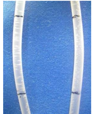
図 4-5-2-32 アミノトリパ 2 回目 図 4-5-2-33 アミノトリパ 2 回目 図 4-5-2-34 アミノトリパ 2 回目 90 分後の輸液ライン 120 分後の輸液ライン 150 分後の輸液ライン 左：球状浮力体あり 左：球状浮力体あり 左：球状浮力体あり 右：球状浮力体なし 右：球状浮力体なし 右：球状浮力体なし
