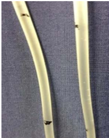
図 4-5-2-28 アミノトリパ 1 回目 120 分後の輸液ライン 左：球状浮力体あり 右：球状浮力体なし
