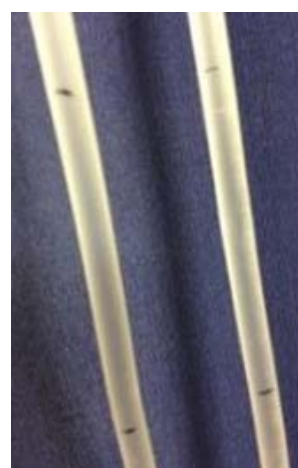
図 4-5-2-40 薬液 フィジオ 35 図 4-5-2-41 フィジオ 35 図 4-5-2-42 フィジオ 35 30 分後の輸液ライン 60 分後の輸液ライン 左：球状浮力体あり 左：球状浮力体あり 右：球状浮力体なし 右：球状浮力体なし
