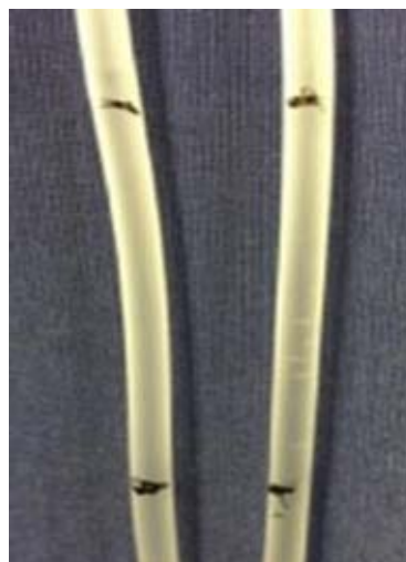
図 4-5-2-25 アミノトリパ 1 回目 30 分後の輸液ライン 左：球状浮力体あり 右：球状浮力体なし
