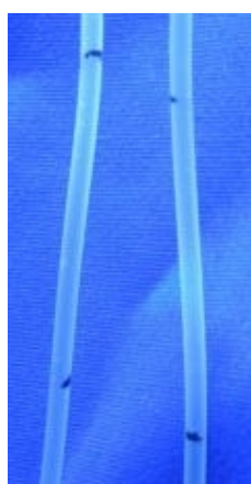
図 4-5-2-12 ラクテック 4 回目 2 時間後の輸液ライン 左：球状浮力体あり 右：球状浮力体なし
