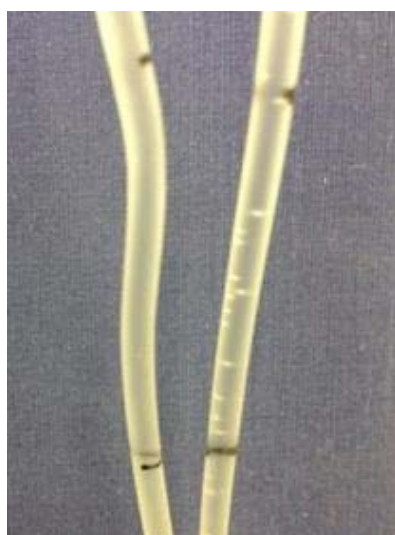
図 4-5-2-3 ラクテック 1回目 2 時間後の輸液ライン 左：球状浮力体あり 右：球状浮力体なし
