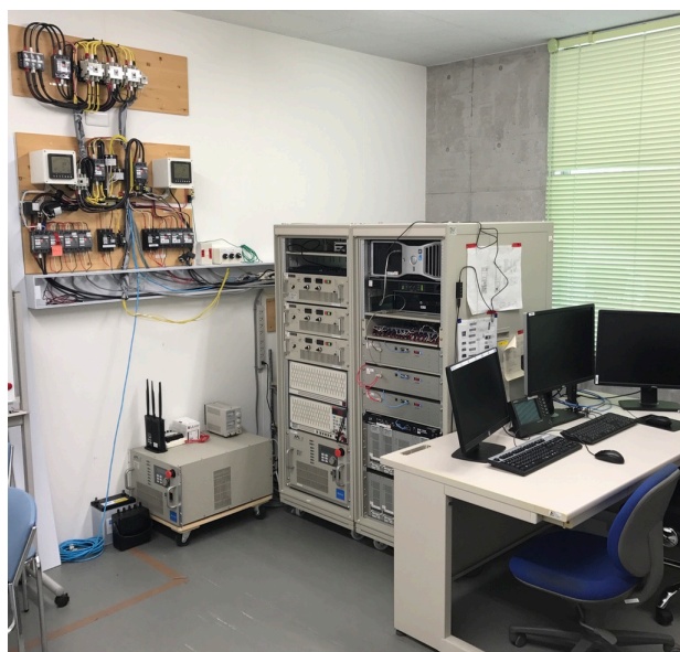
エミュレーションシステム全体 (系統連系および単独切換器を含む)
